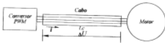
Fig. 5–Tensão auto induzida no cabo ( \Delta U ).
