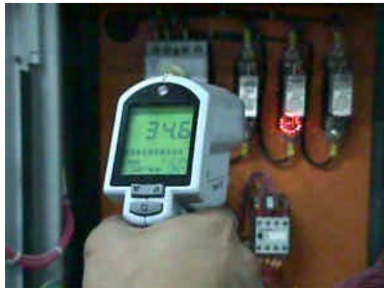
Figura 2 - Exemplo de medição com radiômetro.
